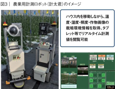
図3 | 農業用計測ロボット(計太君)のイメージ
