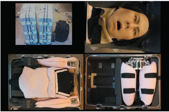
分解し、飛行機の手荷物としてスーツケース2つに収納可能な石黒先生のアンドロイド
