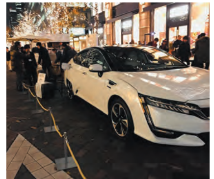
燃料電池車の電気で東京・丸の内のイルミネーションを灯す。こうした平時のV2Xの取組が災害時にも生かされる。
