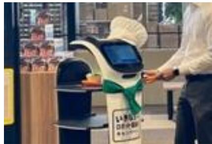
ロボットが自律移動で料理を配膳エリアに運搬
