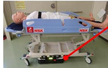
ストレッチャーの下部にアシストロボットを接続し、搬送業務のサポートをする
